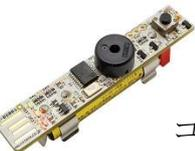
昨年までとは異なり、今年度は実践的に電子機器の制御とアプリケーションの開発を中心に行うとのこと。この日は「計測制御プログラマー」という教材(左写真)を使ってブザーやLEDをコントロールするプログラムを作成していました。プログラミングのコンテストにも参加できるとのことです。ぜひ、頑張ってください！
